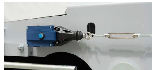
图2：Schmersal的ZQ 900-22紧急停止拉线开关是WeKea模块化系统中的集成防护装置。
