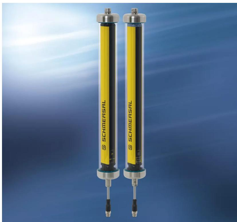
SLC/SLG 440 IP69K安全光幕/光栅的**锁紧螺帽**，电缆入口和紧固部件均**采用不锈钢(V4A)制造**。透明保护管由聚碳酸酯(PC)制成，较为坚固，不仅**对清洗剂具有很高的耐磨性**，还能**承受较强的机械负载**。因此，如果在食品生产或运输的压力清洗过程中，喷枪不小心击中了SLC/SLG 440 IP69K外壳，或是在运输过程中与外壳发生一定程度的碰撞，安全保护功能仍能继
