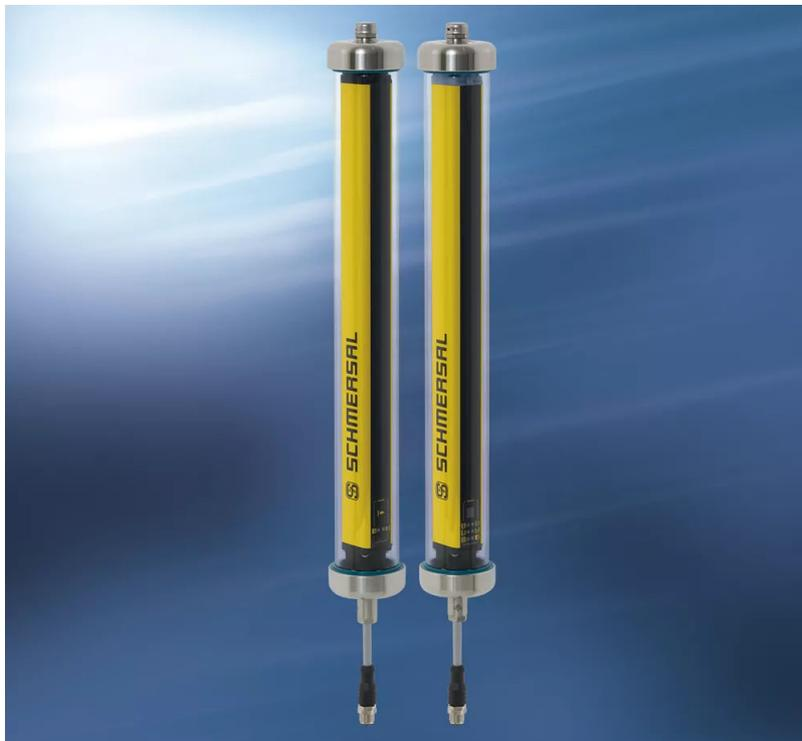
SLC/SLG 440 IP69K安全光幕/光栅的**锁紧螺帽**，电缆入口和紧固部件均**采用不锈钢(V4A)制造**。透明保护管由聚碳酸酯(PC)制成，较为坚固，不仅**对清洗剂具有很高的耐磨性**，还能**承受较强的机械负载**。因此，如果在食品生产或运输的压力清洗过程中，喷枪不小心击中了SLC/SLG 440 IP69K外壳，或是在运输过程中与外壳发生一定程度的碰撞，安全保护功能仍能继续发挥作用。
