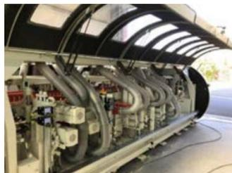
Schroeder 生产线上的加工设备都有保护罩和电磁安全锁
