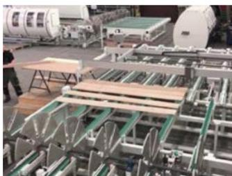
Schroeder 的多层木地板仿形抛光机生产线采用德国施迈赛的模块化 PROTECT PSC1 安全控制器。
