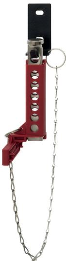
进入危险区域时，工作人员可将挂锁挂在停工标签上。这样可以防止防护门被关闭，从而防止机器意外启动。停工标签适合安装在危险区域的内部和外部。停工标签上最多可以有六把挂锁，这意味着最多可以有六个人同时进入危险区域。
