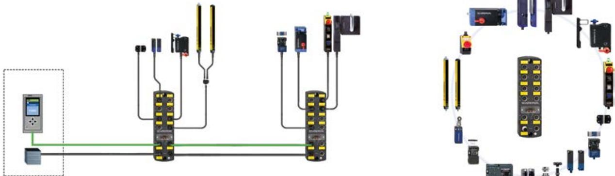
实例解决方案 - 不同的安全开关设备连接到安全现场箱。
